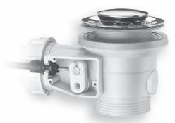
IT La guaina di trasmissione realizzata in PA66 (materiale nylon ad alte prestazioni) con terminali co-stampati è fissata al corpo del troppo pieno e del sottopiletta con un sistema a pressione senza l'ausilio di blocaggi meccanici che potrebbero determinare imprecisioni nel tempo e risulta perfettamente inamovibile.
