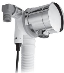
IT Bocca erogazione in ottone con aeratore, corredato di anello di spessore che permette un ottimale montaggio della bocca erogazione senza minimamente incidere la superficie della vasca, garantendo un'ottimale evacuazione al troppo pieno. Possibilità di installazione su vasche con spessore da 2 mm a 14 mm.
