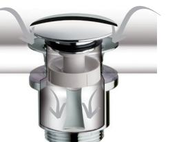
IT Al passaggio dell'acqua la membrana si comprime permettendo il naturale deflusso.
